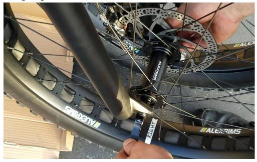
WARNING: MAKE SURE TO TIGHTEN THE QUICK-RELEASE IN THE FORK SO THAT THE WHEEL CANNOT FALL OUT OF THE FORK; FAILURE TO ADEQUATELY TIGHTEN THE QUICK-RELEASE CAN RESULT IN ACCIDENTAL RIDER INJURY OR DEATH.
