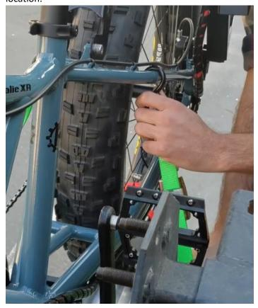
WARNING DO NOT PLACE THE HOOK ON TOP OF THE BRAKE LINE AS YOU MAY DAMAGE THE BRAKE LINE WHEN TIGHTENING THE CAM-BUCKLE STRAP.
